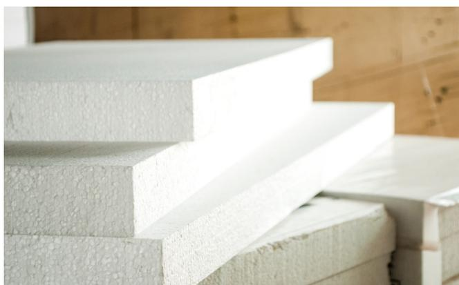
↑ Matériau isolant en polystyrène
