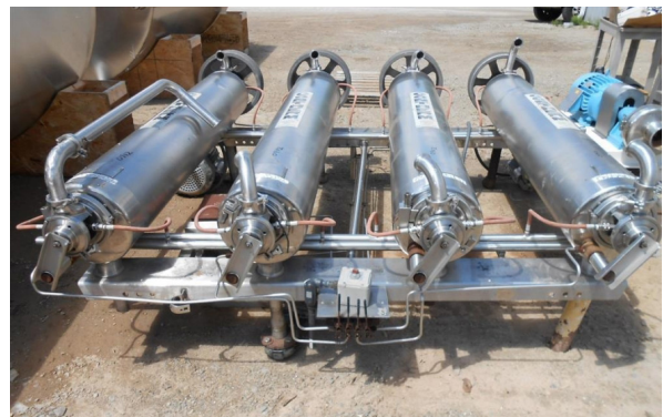
↑ Echangeur de Chaleur à Surface Raclée Contherm
