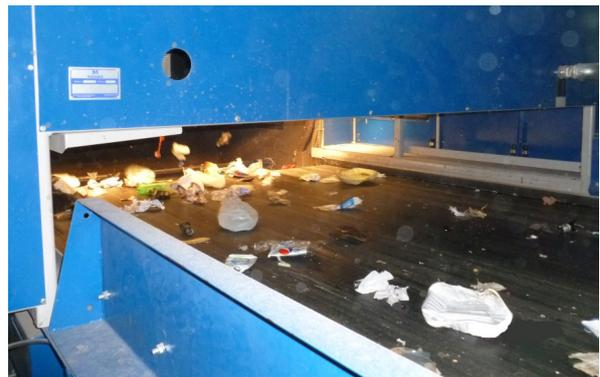
↑ Convoyeur de Trieur Optique
